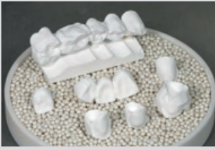
Рис. 14 Реставрационные конструкции, подготовленные для обжига при высокой температуре
