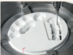
Рис. 12 Фрезерование мостов боковых зубов 18-14-13
