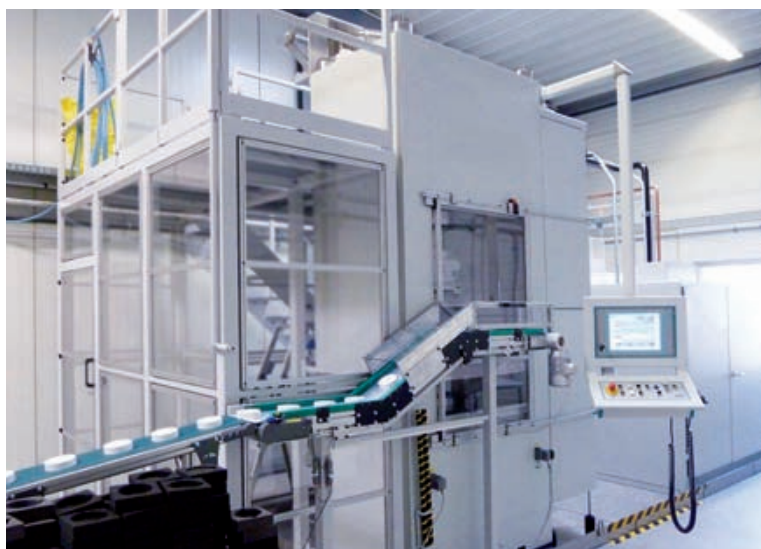
Рис. 3 Мощный автоматический гидравлический пресс
